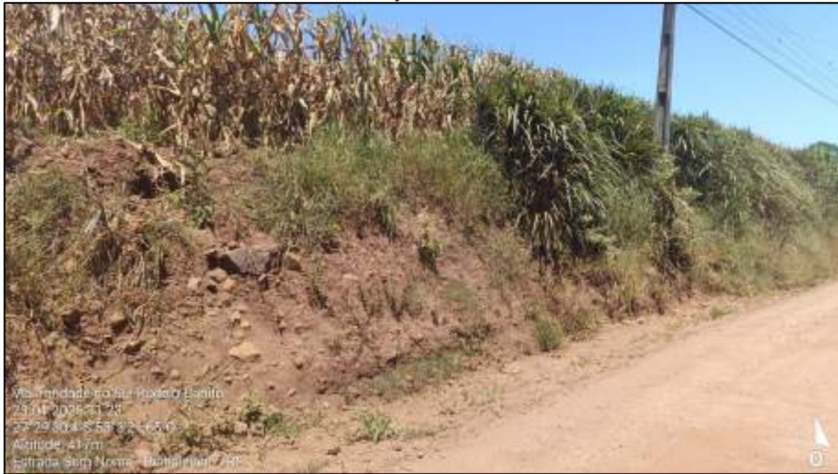
Figura 44. Começo de surgência de camada de maio relevância de solo, onde pode ser visualizada uma mescla com o basalto fragmentado encontrado em regiões próximas, com decomposição angulosa do maciço rochoso.
