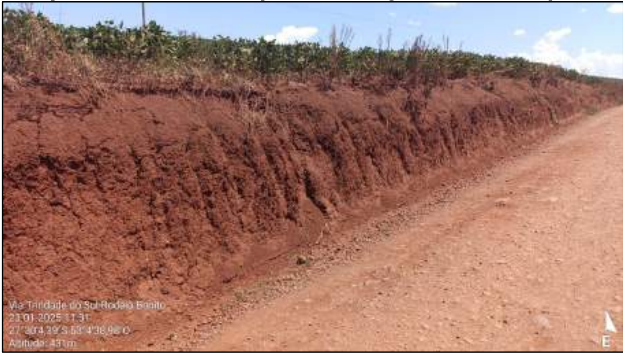
Figura 46. Com o acompanhamento gradual da topografia possível visualizar o surgimento de uma espessura de solo, onde abaixo se pode verificar a surgência de basalto decomposto.
