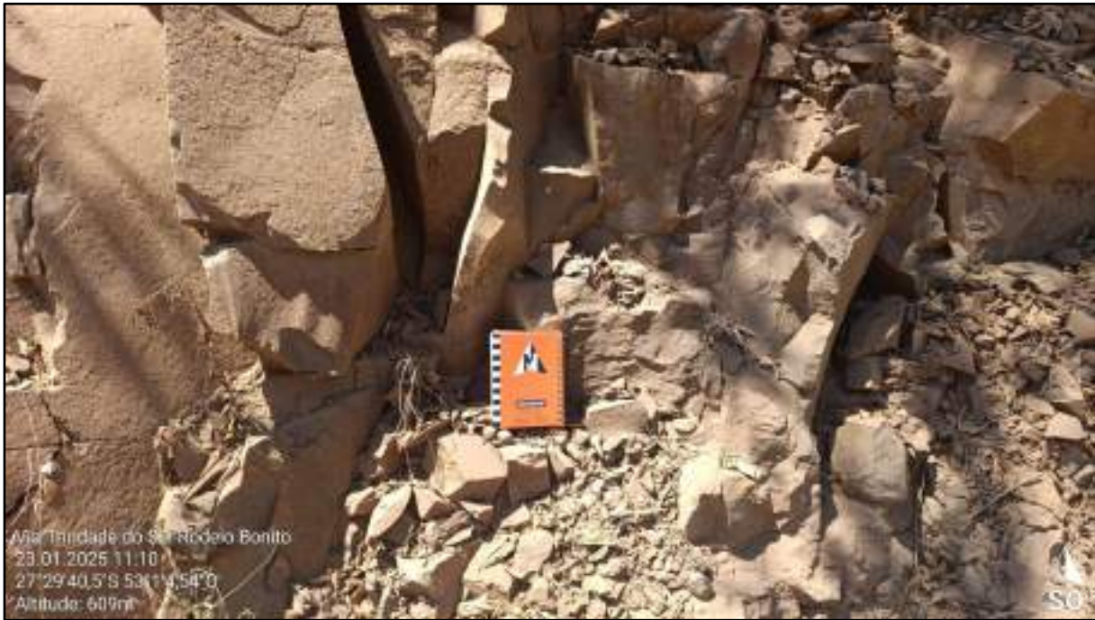
Figura 42. Em uma análise mais aprofundada é possível verificar uma maior quantidade de famílias de fraturas verticalizadas, com uma menor incidência de fraturar horizontalizadas.
